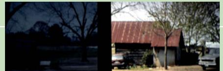
Durch die 3D-Brille von JVC erscheint das Bild auf der Spalluto WS S CinemaFrame Ambient HC dunkel (links), während es auf einer standardweißen Gain-1,0-Leinwand (rechts) korrekt abgebildet wird.
