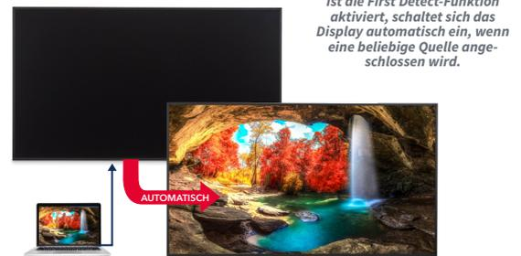
Da sich bis zu drei Eingangsquellen priorisieren lassen, bleibt der Signage-Content selbst dann sichtbar, wenn die erste Quelle ausfallen sollte.
